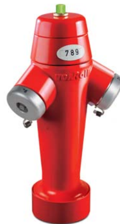
Fig. 5522 2 sorties latérales au choix 2x75, 2x55 ou 75/55 Storz Poids: 42 kg
