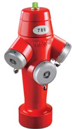
Fig. 5532 2 sorties latérales au choix 2x75, 2x55 ou 75/55 Storz et tubulure centrale de transport de l'eau Storz 75 Poids 59 kg
